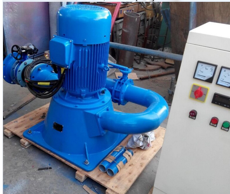
Turbina Pelton Comercial, com exposição de Roda Pelton .
