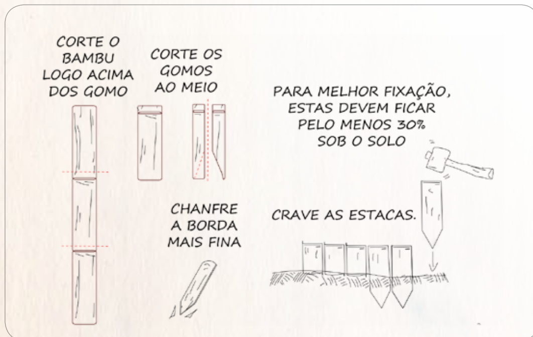
Corte de bambu para uso como delimitador.
